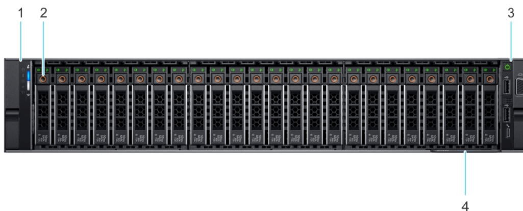
Ilustración 3. Vista frontal del sistema de unidades de 24 x 2,5 pulgadas
